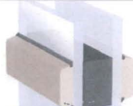
Sprossen beidseitig aufgesetzt mit Steg im Scheibenzwischenraum
