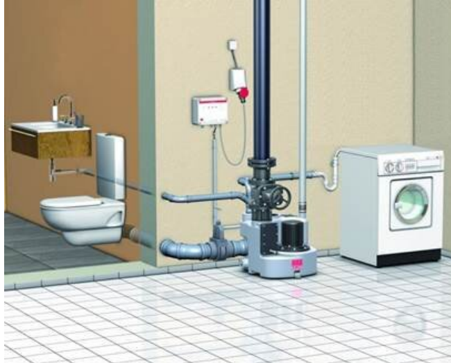
Unterflur Hebeanlage Fäkalienhaltig
